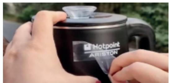
7. Lascia il transfer applicato per 24 ore prima di effettuare test di tenuta, in modo che l'adesivo arrivi al massimo punto di adesione.
